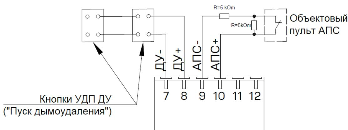
Рис. 5. Схема подключения пульта АПС и кнопок дымоудаления.
