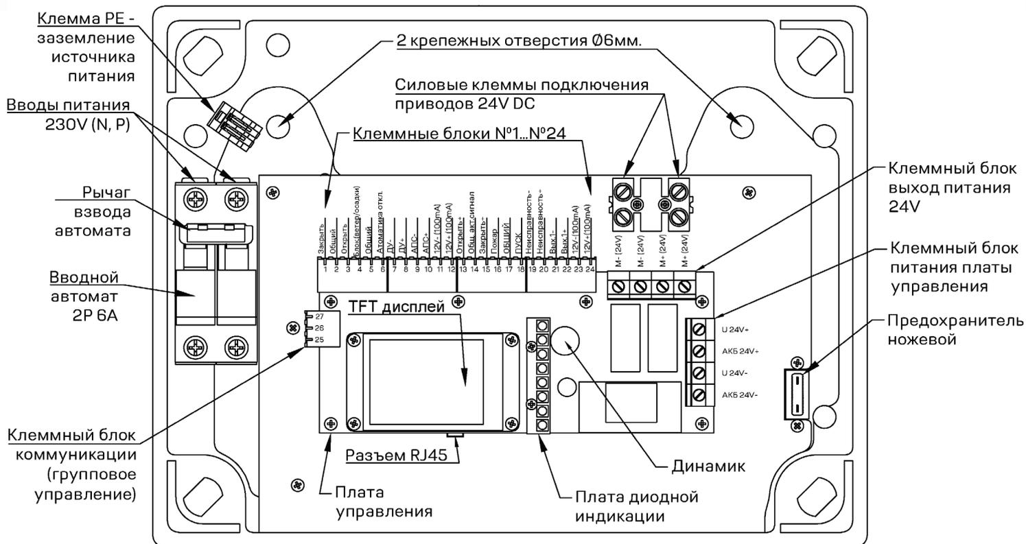
Рис. 2. Органы управления
