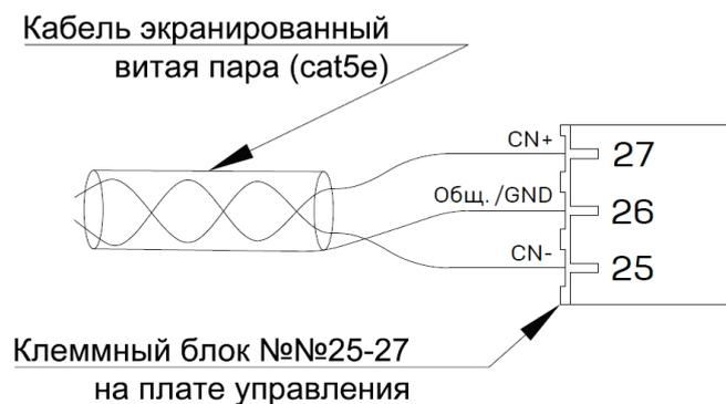
Рис. 8. Схема подключения коммуникационной шины (групповое управление).
